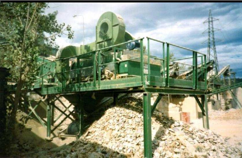
**Il Gruppo di Separazione dei Leggeri** viene solitamente installato negli impianti di recupero inerti dopo la prima frantumazione e viene utilizzato per raffinare il trattenuto del vaglio che separa la parte fine polverosa.
